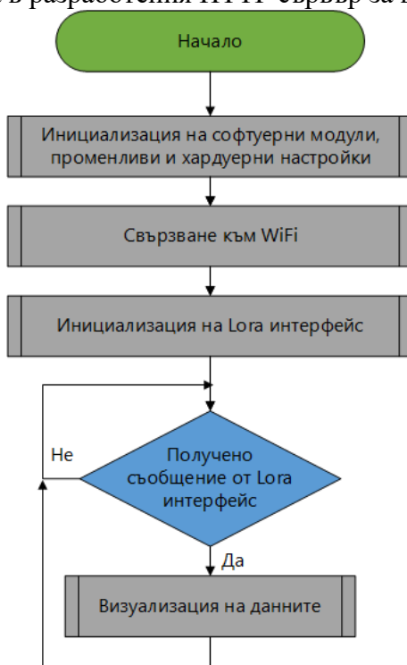
Фигура 3 Алгоритъм на софтуера в модула тип Gateway за визуализация
